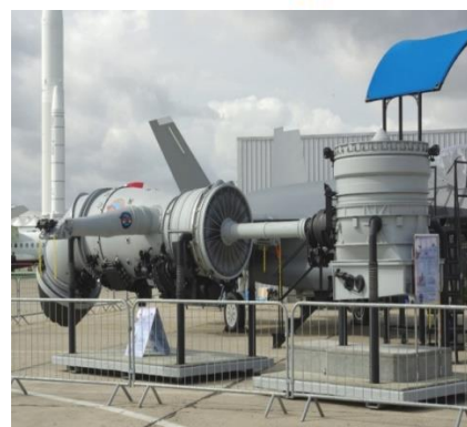
شکل ۱-الف: کنترل بردار تراست مکانیکی هواپیمای اف-۳۵. شکل ۱-ب: موتور هواپیمای اف-۳۵ [۳].
