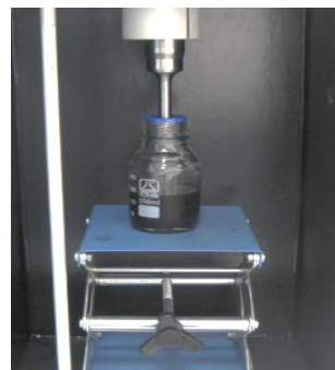
شکل ۵: دستگاه اولتراسونیک پروبی مورد استفاده در پژوهش
