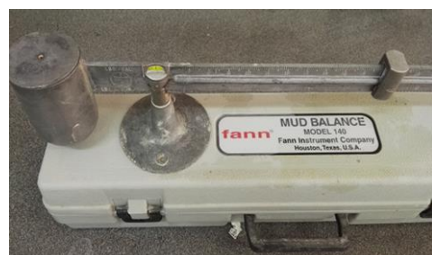
شکل ۵، ترازوی گل مدل ۱۴۰ ساخت شرکت Fann آمریکا
