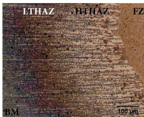
شکل (۸): ریز ساختار منطقه‌ی متأثر از حرارت (HAZ) فولاد دوبلکس
