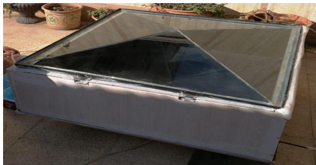
شکل ۶: قرار دادن پوشش شیشه ای روی حوضچه
