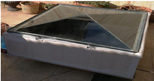
شکل ۶: قرار دادن پوشش شیشه ای روی حوضچه
