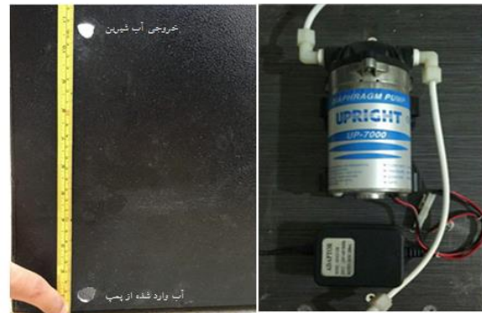
شکل ۴: سوراخ های ورودی و خروجی آب و پمپ آب
