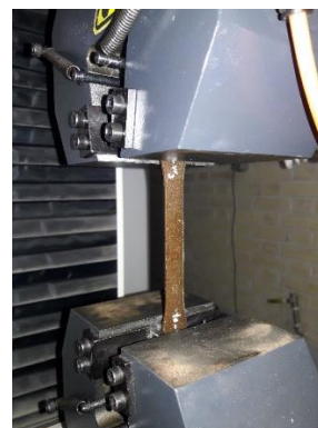
شکل ۷: نمونه تحت آزمون کشش
