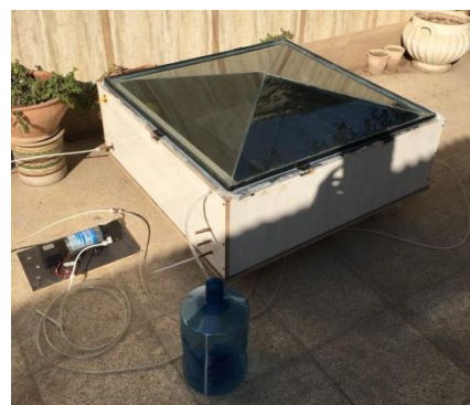
شکل ۱: تصویر واقعی دستگاه آب شیرین کن خورشیدی
