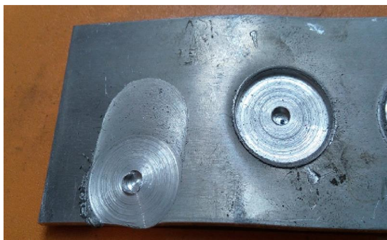
شکل ۱۵- حرکت کردن صفحه در هنگام فرود آمدن ابزار و در نتیجه خراب شدن جوش زده شده
