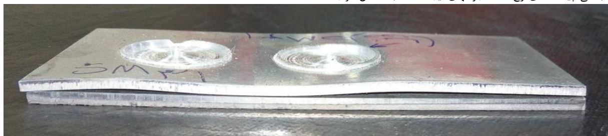
شکل ۱۳- تابیده شدن صفحه‌ی آلومینیومی در اثر حرارت اصطکاکی زیاد و بوجود آمدن عیب در نمونه
