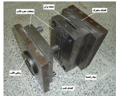
شکل ۴: قالب تزریق
