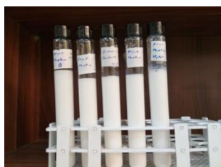
شکل ۵: نانوسیال اتیلن گلیکول-اکسیدروی در قطر ۲۰ نانومتر و کسر حجمی های مختلف
