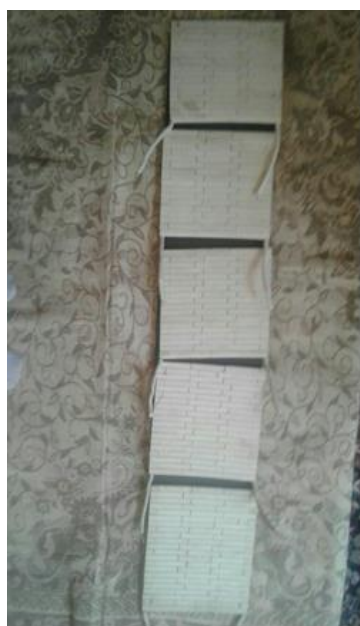
شکل ۱۱-المنت سرامیکی روی صفحه‌ی فلزی
