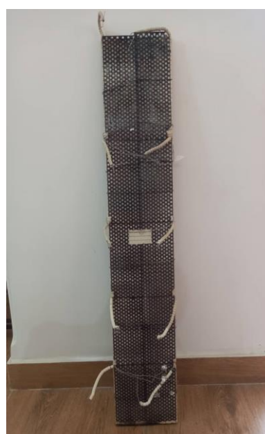
شکل ۱۰-المنت سرامیکی چسبیده به صفحه مشبک فلزی
