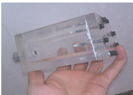
شکل ۶- محفظه خلا مورد استفاده در تست
