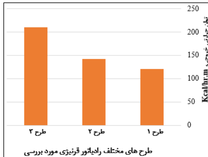
شکل ۶. نمودار مقایسه برآورد توان گرمایشی رادیاتور های قرنیزی نوع ۱ و ۲ و ۳ مطابق گزارش آزمایشگاه استاندارد
