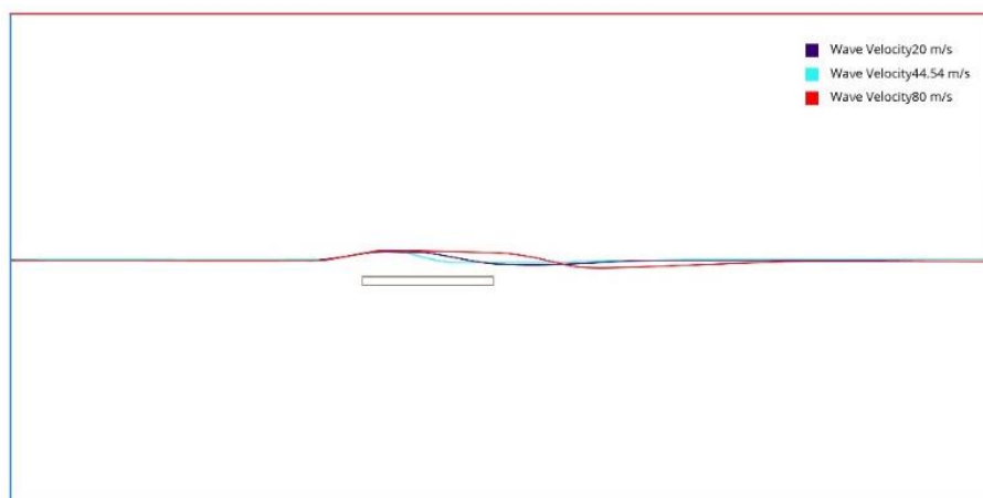
شکل ۵- موج ایجاد شده بر سطح آزاد آب در اثر حرکت سیلندر در عمق H/D = 2 از سطح آب در سه سرعت مختلف.
