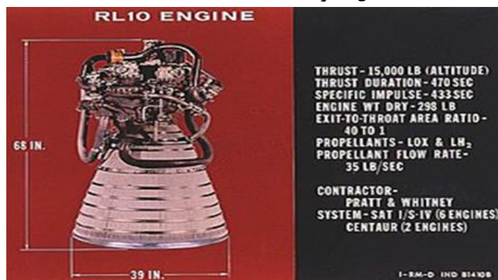
شکل ۲: جزئیات موتور موشک کرایونیک RL-10 [۲]
