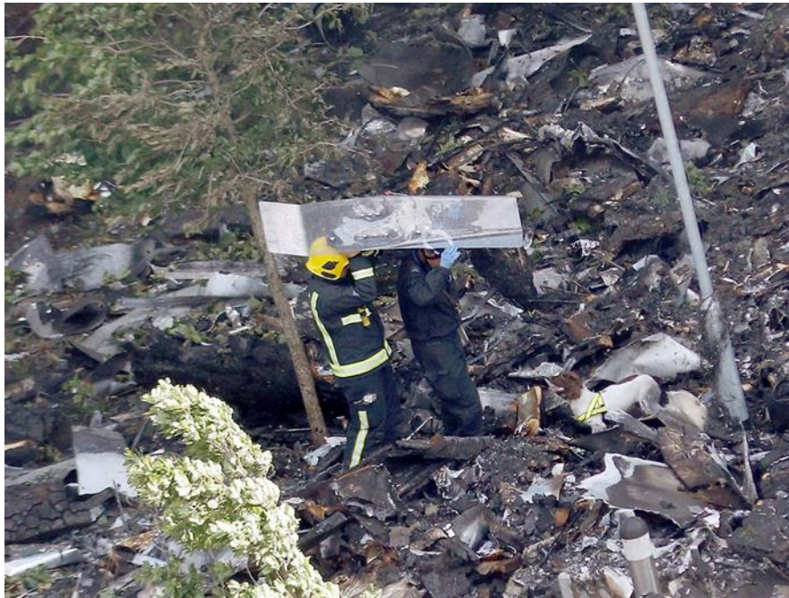
شکل ۲-۳۱ ریزش مصالح نما قابل اشتعال در اطراف برج گرنفل [۳]
