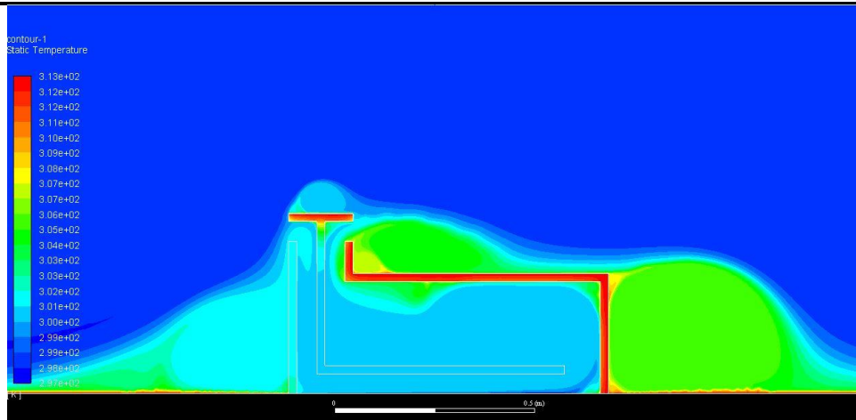
شکل ۲۸: کانتورهای دما برای حالت جذب حرارت 100 \text{ W/m}^2
