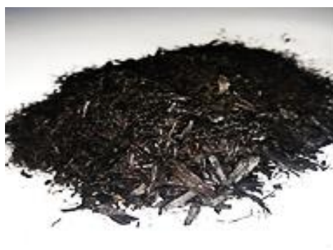
شکل ۱: زغال باگاس نیشکر مورد استفاده در پژوهش
