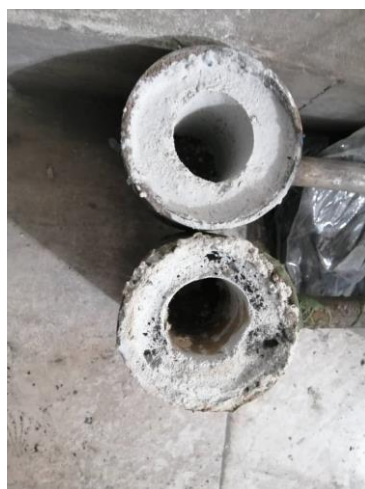
شکل ۵: تهیه بوته برای نمونه حاوی ۲۰ درصد زیرکونیا
