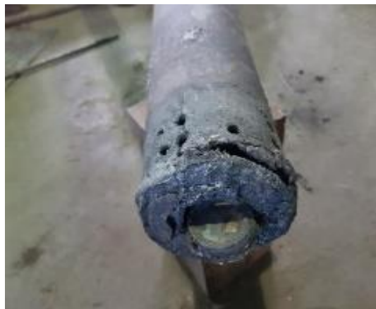
شکل ۱: سوختگی و آسیب دیدگی سر مشعل
