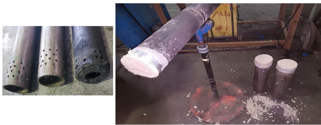
شکل ۱۲: مشعل نهایی ساخته شده مطابق طرح شماره ۲
