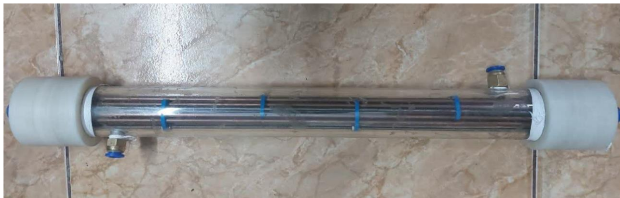
شکل-۲: تصویری از مبدل حرارتی مینی کانال پوسته-لوله مورد استفاده در مطالعه حاضر
