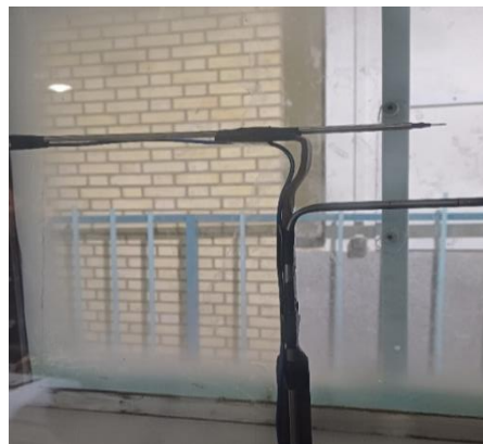
شکل ۶. پراب دستگاه جریان سنج سیم داغ متصل در کنار لوله پیتو
