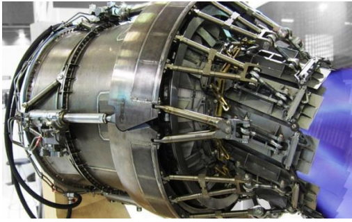
شکل ۲: یک نمونه سیستم کنترل بردار تراست مکانیکی برای موتور جنگنده اف-۱۵ [۴].
