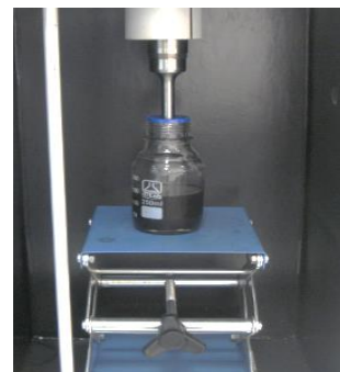
شکل ۵: دستگاه اولتراسونیک پروبی مورد استفاده در پژوهش
