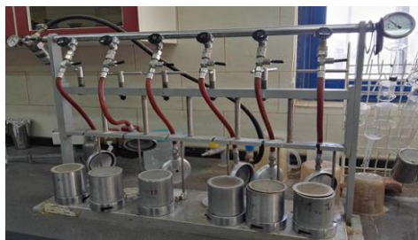
شکل ۱۱، دستگاه لوبریسیتی تستر مدل 212EP ساخت شرکت FANN آمریکا
