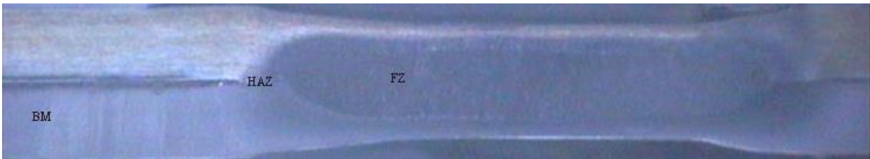
شکل (۶): ماکرو ساختار اتصال جوش مقاومت نقطه ای فولاد زنگ نزن
