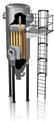
شکل ۲: نمای از فیلتر و نمایش کیسه‌ها و صفحه مانع
