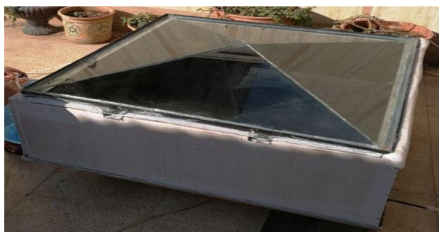
شکل ۶: قرار دادن پوشش شیشه ای روی حوضچه
