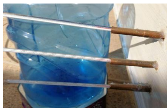
شکل ۵: دماسنج های میله ای جهت اندازه گیری دمای آب شور در ارتفاعات مختلف
