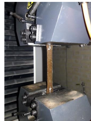
شکل ۷: نمونه تحت آزمون کشش
