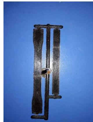
شکل ۶: نمونه تولید شده از ترکیب باگاس و پلی پروپیلین
