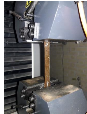
شکل ۷: نمونه تحت آزمون کشش
