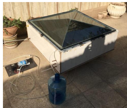
شکل ۱: تصویر واقعی دستگاه آب شیرین کن خورشیدی
