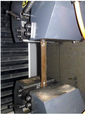
شکل ۷: نمونه تحت تست کشش
