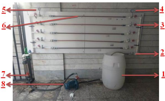
شکل ۳ سیم آزمایشگاهی اندازه گیری افت فشار
