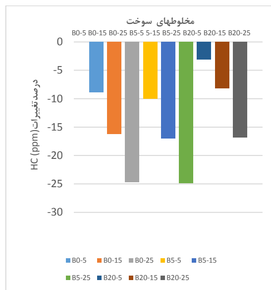
شکل ۸: درصد تغییرات هیدروکربن‌های نسوخته موتور با استفاده از ترکیبات سوخت نانو بیودیزل و دیزل نسبت به سوخت دیزل خالص
