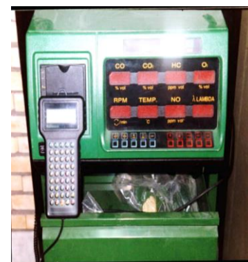
شکل ۴: دستگاه اندازه‌گیری آلاینده‌های موتور
