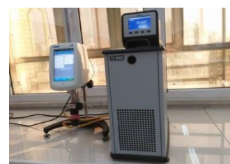
شکل ۴: نمایی از دستگاه های ویسکومتر بروکفیلد و حمام دمایی
