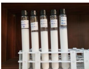
شکل ۵: نانوسیال اتیلن گلیکول-اکسیدروی در قطر ۲۰ نانومتر و کسر حجمی های مختلف
