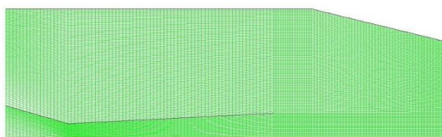
شکل ۴ - شماتیک از مش بندی در ناحیه گلوگاه نازل
