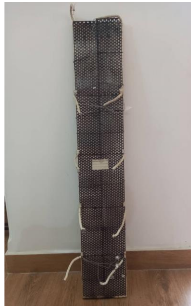
شکل ۱۰-المنت سرامیکی چسبیده به صفحه مشبک فلزی
