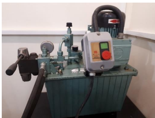
شکل (۲): واحد توان مورد استفاده در پژوهش به همراه سوپاپ کنترل جهت ۳/۴
