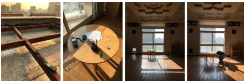
شکل ۴ برداشت میدانی و نورسنجی در وضعیت پوشاندن رف‌های نوری و دریچه‌های دیوار ترومب و همچنین دیتالاگر بر روی بام
