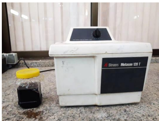
شکل ۲: حمام آلتراسونیک مورد استفاده
