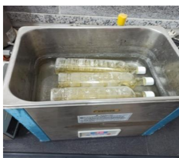
شکل ۳- مراحل پراکنده شدن نانوذرات در نانو روانکار به وسیله دستگاه آلتراسونیک.
