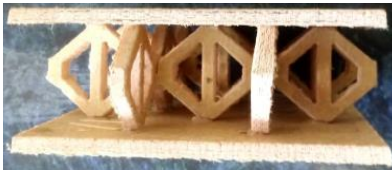
شکل ۴: نمونه نهایی از ساندویچ پانل ساخته شده الیاف کولار
