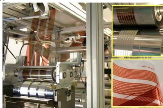
شکل ۱۱: (الف) طرح‌واره‌ای از فرآیند چاپ گراور و (ب) نمونه‌ای از دستگاه تولید سلول خورشیدی به روش گراور [۶۲]
