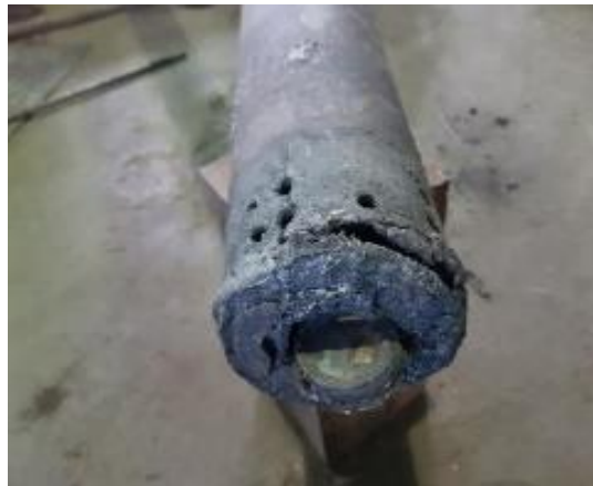
شکل ۱: سوختگی و آسیب دیدگی سر مشعل
