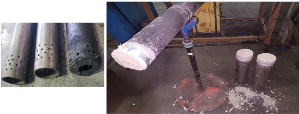
شکل ۱۲: مشعل نهایی ساخته شده مطابق طرح شماره ۲
