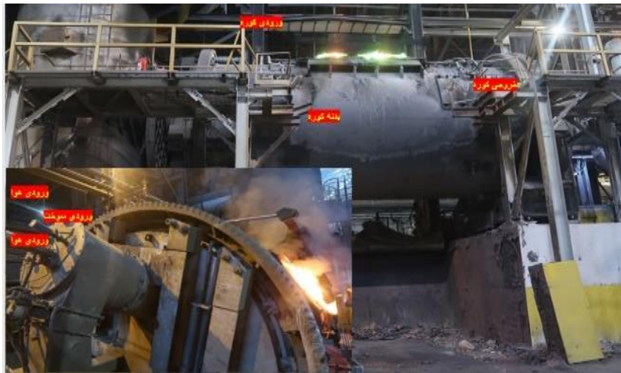
شکل ۲: تصویر کوره آند و نحوه قرارگیری مشعل داخل کوره
