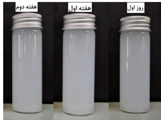
شکل ۴: تست پایداری نانوسیالات در غلظت ۲٪ جرمی
