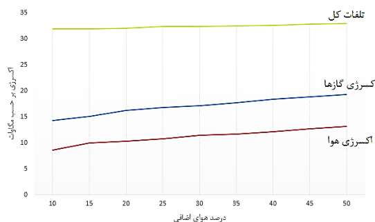
شکل (۸): تأثیر تغییرات درصد هوای اضافی بر اکسرژی گاز، هوا و تلفات اکسرژی کل
