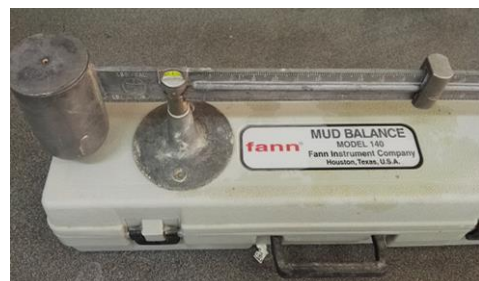
شکل ۵، ترازوی گل مدل ۱۴۰ ساخت شرکت Fann آمریکا
