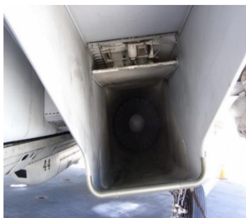
شکل ۲. پخش‌کننده موتور توربوفن هواپیمای اف ۱۴ [۶]
